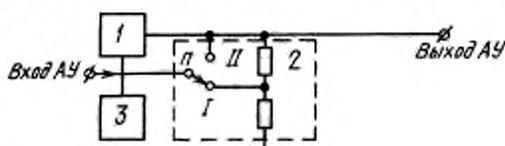
1 — АУ; 2 — аттенюатор; 3 — электронный милливольтметр; П — переключатель
