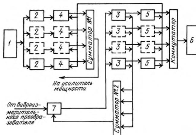
1 — генератор шума; 2 — формирующие фильтры; 3 — анализирующие фильтры; 4 — автоматические регуляторы усиления; 5 — детекторы; 6 — индикатор; 7 — измеритель виброускорения
