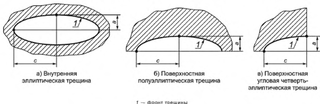
Рисунок 9.1 — Виды расчетного дефекта в элементах ВКУ
