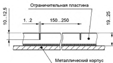
Рисунок 4 — Пазы в ограничительной пластине однослойной футеровки
