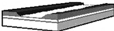
Рисунок 4 — Сочетание первичной модификации (1/2/3) вторичного процесса усиления внесением или обнажением красителя (комбинированная ЛМ)
