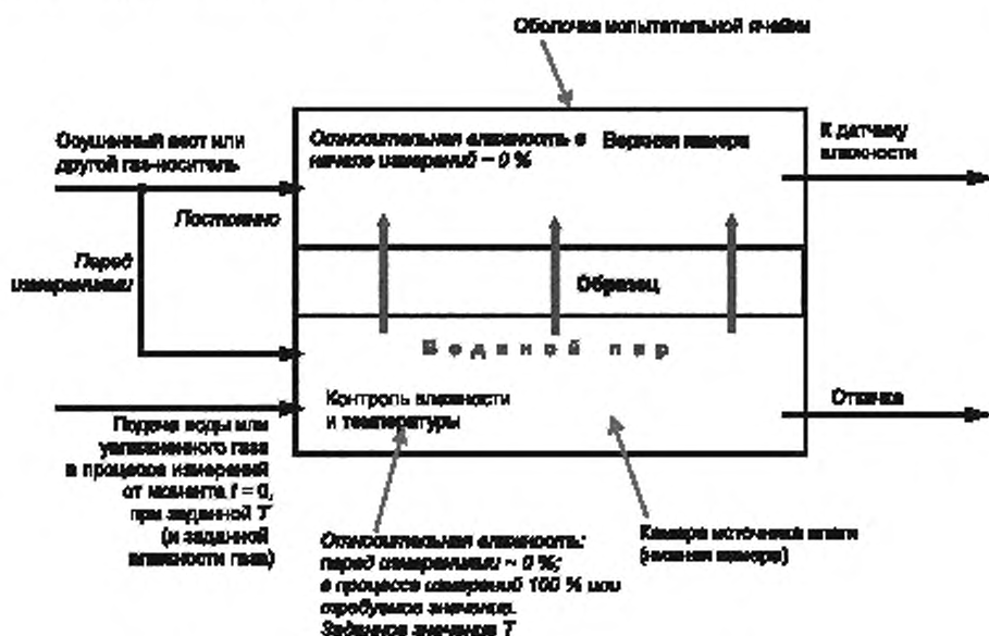
Рисунок 1 — Схема принципа действия испытательной ячейки
