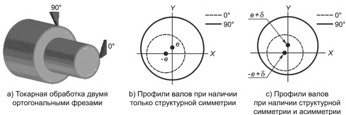
Рисунок А.13 — Профили валов для многоориентированного поворота при наличии структурной симметрии и структурной асимметрии
