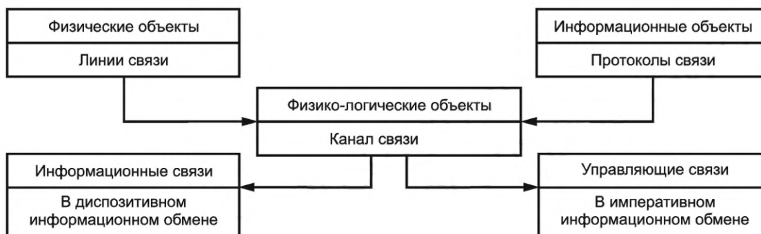
Рисунок 4 — Образование информационных и управляющих связей
