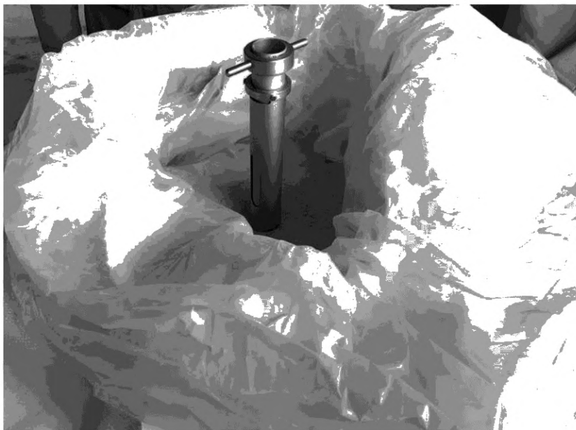
Рисунок 3 — Отбор точечных проб пробоотборной трубкой из упакованного материала
