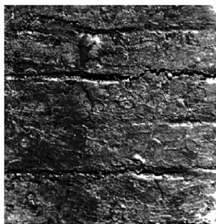
б — внешний вид дефекта на грани заготовки
