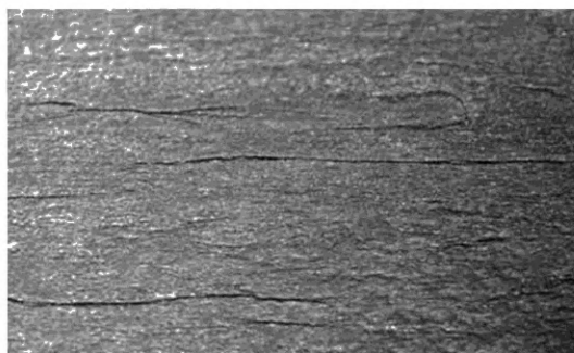
б — внешний вид дефекта на поверхности после стравливания окалины
