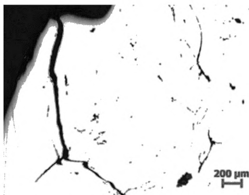
б — микроструктура в зоне дефекта с неметаллическими включениями, 50 х
