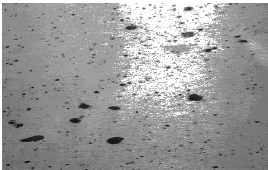
а — внешний вид пятен загрязнения
