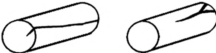
б — дефект на сортовом прокате
