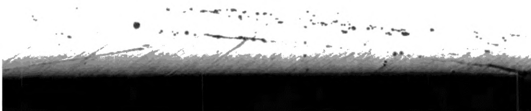
в — вид дефекта на микрошлифе (сопровождающийся строчками неметаллических включений), 100 x
