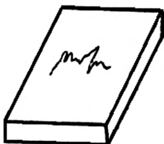
а — дефект на плоском прокате
