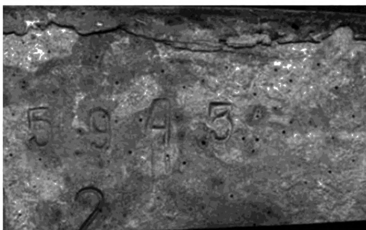
б — внешний вид дефекта на поверхности непрерывнолитой заготовки
