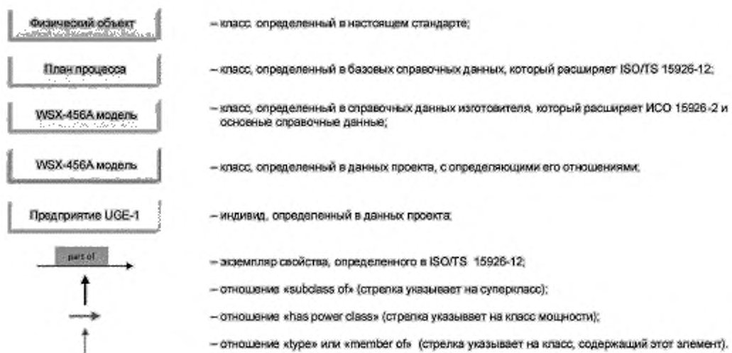
Рисунок 1 — Нотация, используемая для изображения экземпляров в ИСО 15926
