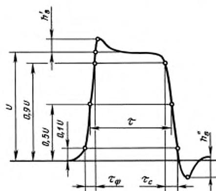
$U$  — амплитуда сигнала;  $\tau$  — активная длительность сигнала;  $\tau_{\phi}$  — активная длительность фронта;  $\tau_c$  — активная длительность среза;  $h'_a, h''_a$  — выбросы на вершине и в паузе
