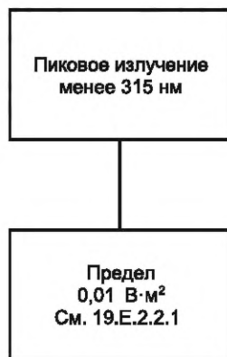
Рисунок F.1 — Блок-схема, учитывающая излучение UVB и UVC
