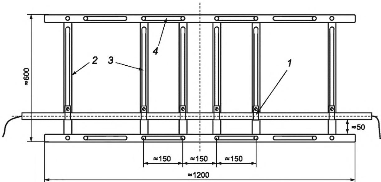
1 — P-образный хомут; 2 — вертикальный несущий элемент; 3 — слот для крепления P-образных хомутов; 4 — слот для крепления вертикальных элементов
