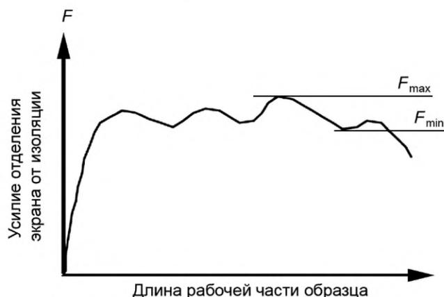
Рисунок 2 — Усилие отделения электропроводящего экрана от изоляции
