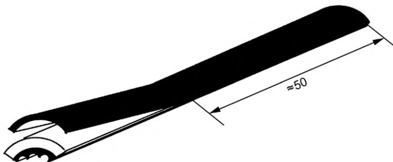
Рисунок 1 — Проверка отделяемости экструдированного электропроводящего экрана
