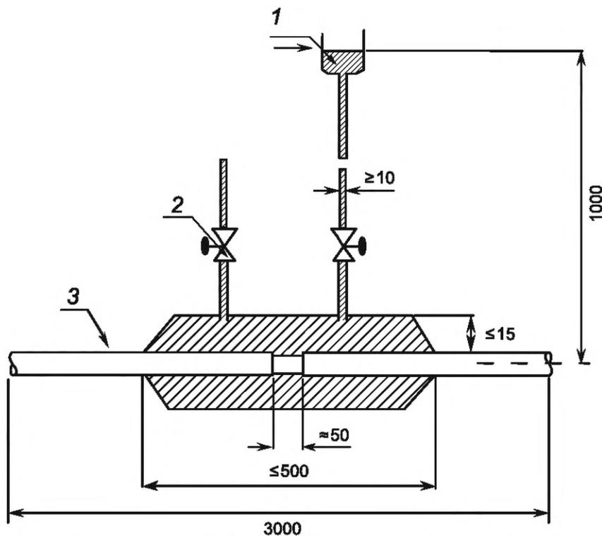
1 — резервуар с водой; 2 — вентиляционное отверстие; 3 — кабель
