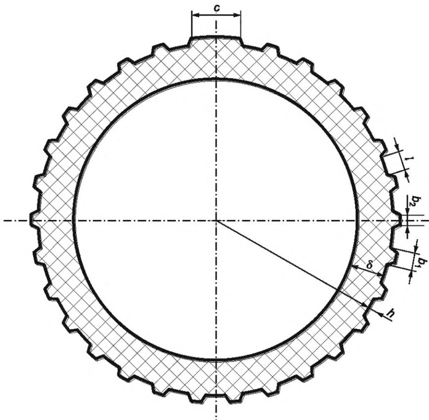
$c$  — ширина маркировочной площадки 10—15 мм;  $h$  — высота ребер (не менее 0,8 мм);  $b_1$  — ширина ребер жесткости у основания трапеции 2,0—2,6 мм;  $b_2$  — ширина ребер жесткости в вершине трапеции 1,2—1,6 мм;  $l$  — расстояние между основаниями ребер 1,5—3,0 мм;  $\delta$  — радиальная толщина оболочки, равная номинальной толщине наружной оболочки, мм
