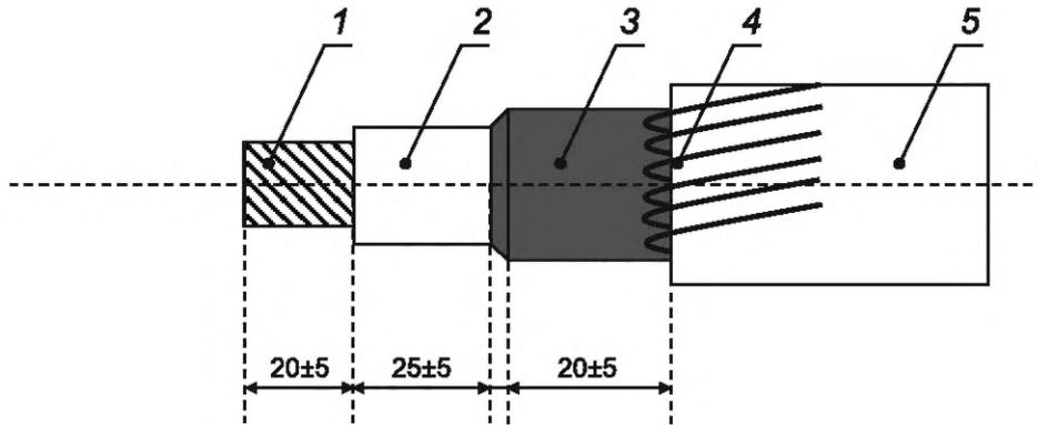
1 — токопроводящая жила; 2 — изоляция; 3 — полимерный электропроводящий экран по изоляции; 4 — металлический экран; 5 — наружная оболочка
