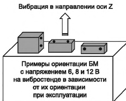
Рисунок 3 — Пример ориентации МБ на вибростенде по отношению к их ориентации в ЛТС при эксплуатации
