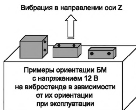
Рисунок 2 — Пример ориентации МБ на вибростенде по отношению к их ориентации в ЛТС при эксплуатации
