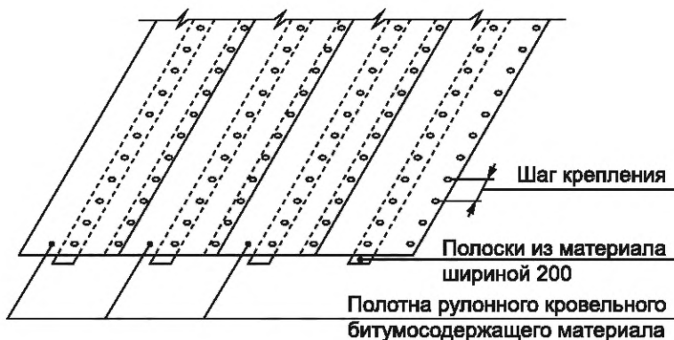
Рисунок 13 — Схема крепления рулонного кровельного битумосодержащего материала для однослойного водоизоляционного покрытия по центру рулона
