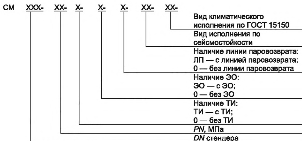
Рисунок 1 — Схема условного обозначения стендера
