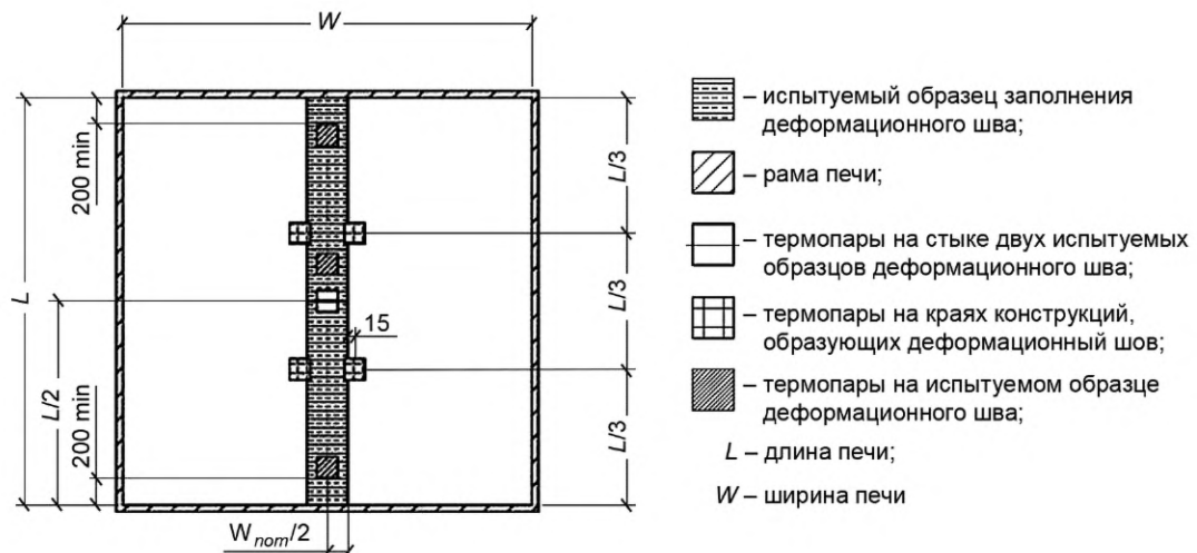
Рисунок 14 — Типовая схема расстановки термодар (горизонтальная печь)
