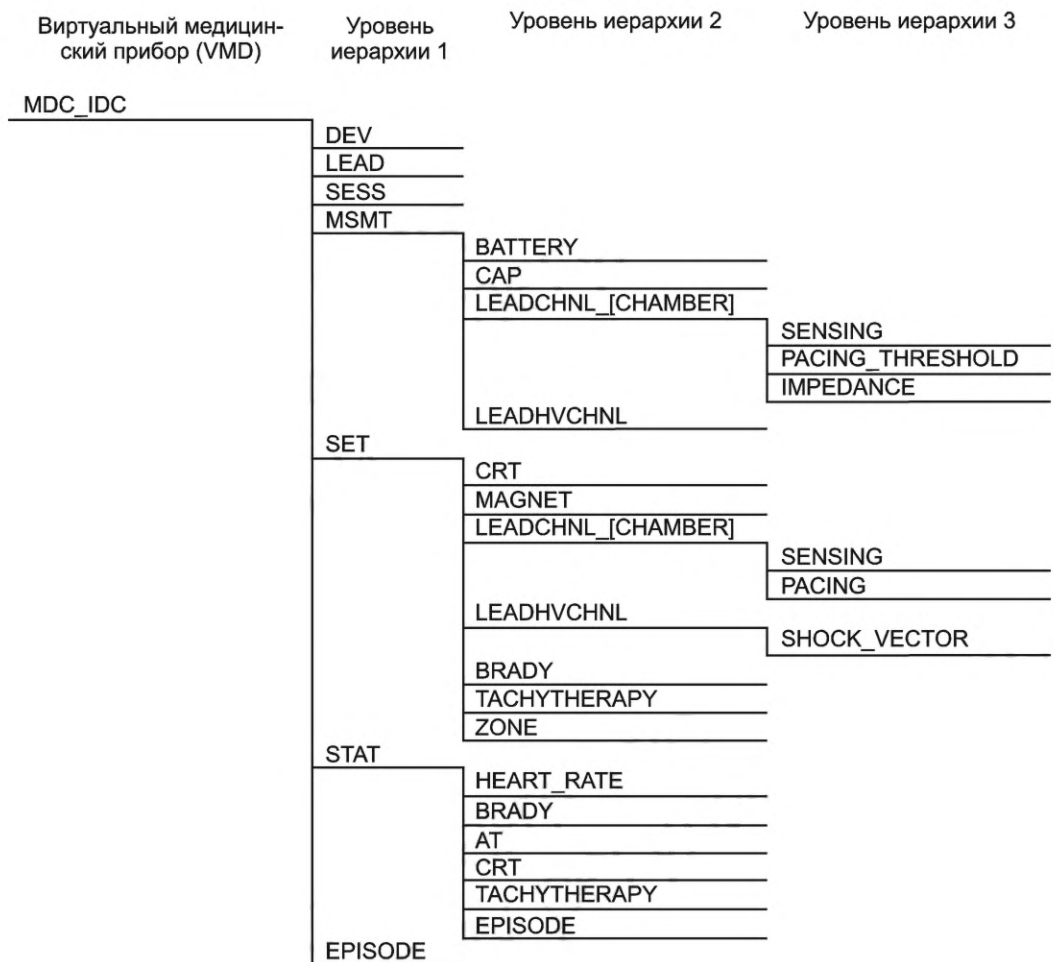
Рисунок 3 — Иерархическая структура содержания, используемая в настоящем стандарте
