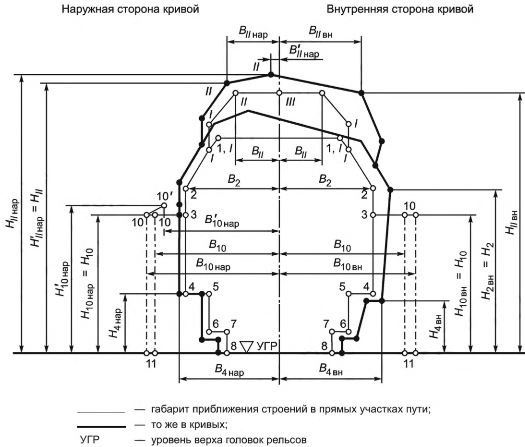
Рисунок Ж.1 — Принцип построения габарита приближения строений С в кривых по проектным нормам
