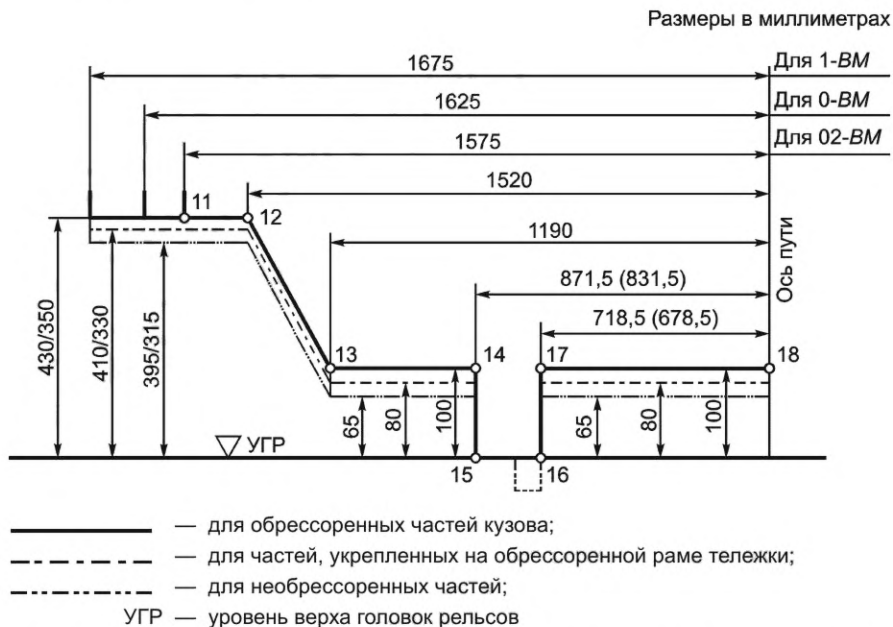
Рисунок 15 — Нижнее очертание габаритов для подвижного состава, не проходящего сортировочные горки, оборудованные вагонными замедлителями
