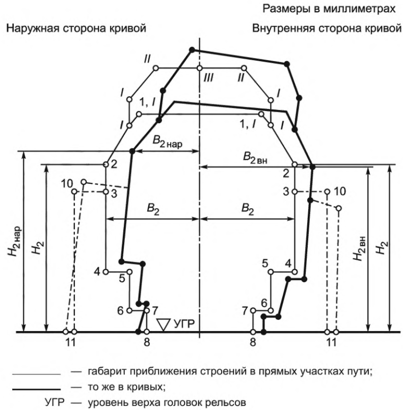
Рисунок Ж.2 — Принцип построения габарита приближения строений С в кривых по эксплуатационным нормам
