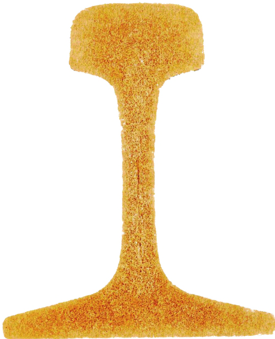
Рисунок И.5 — Незначительная прямая ликвация (серный отпечаток)
