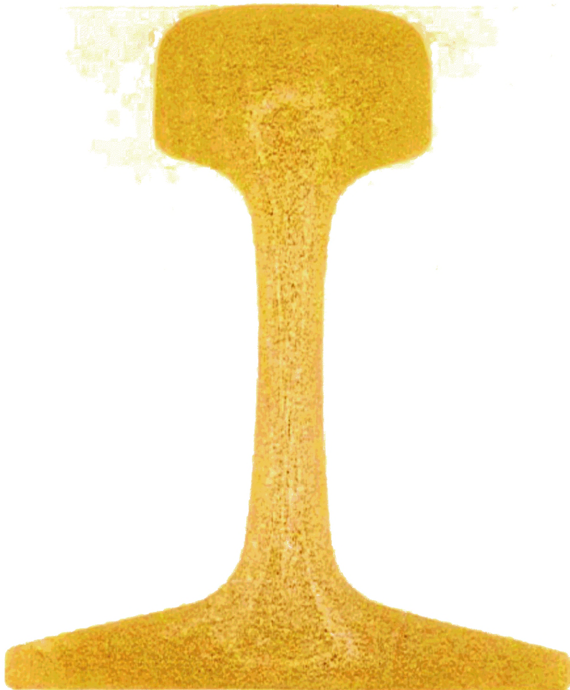
Рисунок И.4 — Отрицательная зонная ликвация, обусловленная электромагнитным перемешиванием (серный отпечаток)
