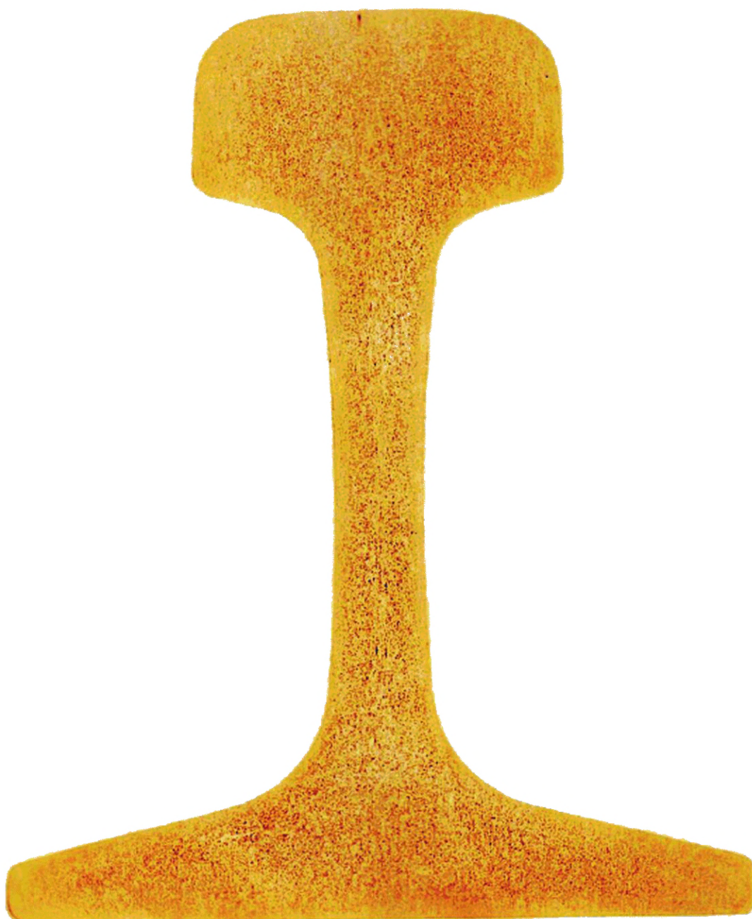
Рисунок И.1 — Макроструктура без ликвации (серный отпечаток)
