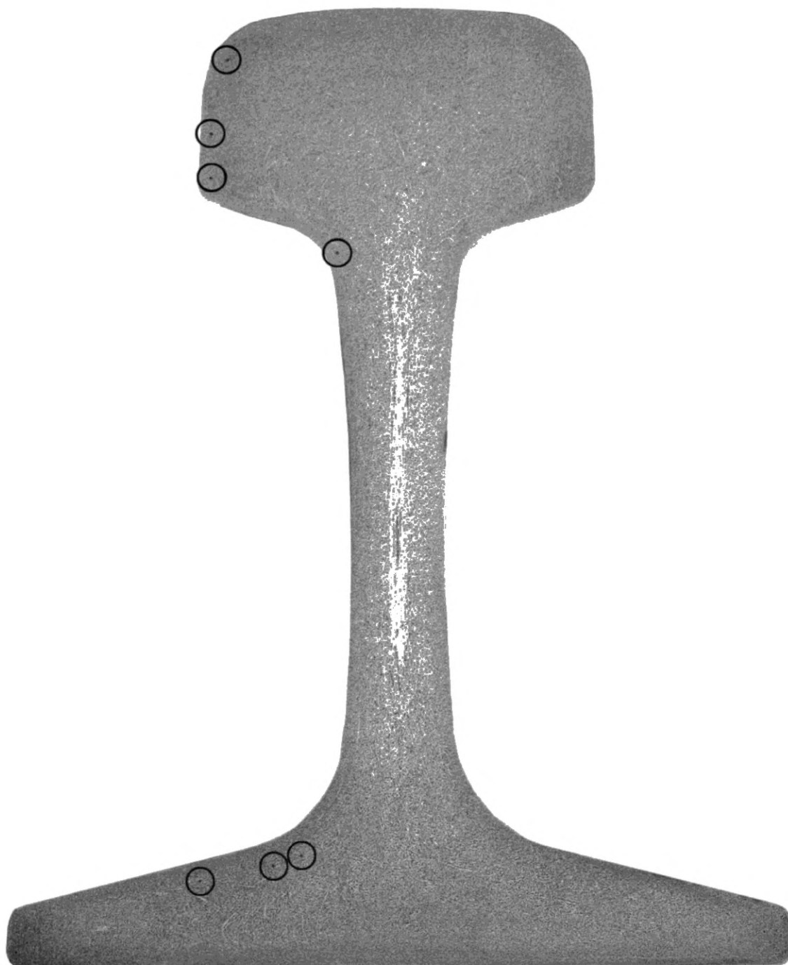
Рисунок И.12 — Наличие более шести одиночных точек на поперечном сечении рельса (глубокое травление)
