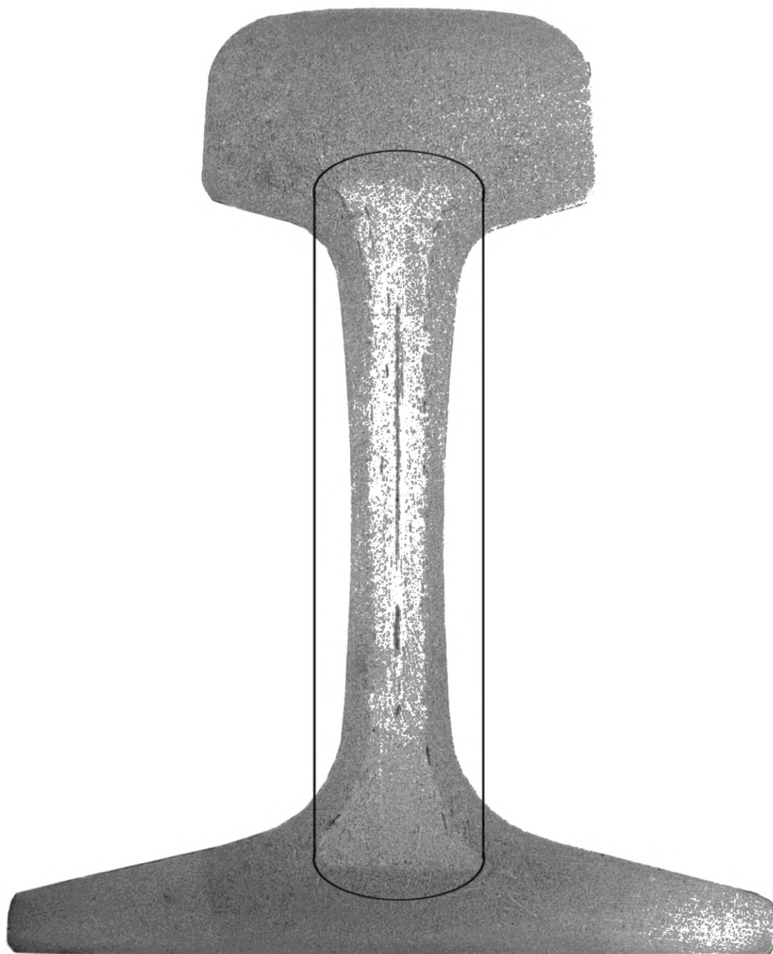
Рисунок И.8 — Ликвационная зона, имеющая ширину, превышающую 1/3 толщины шейки (глубокое травление)
