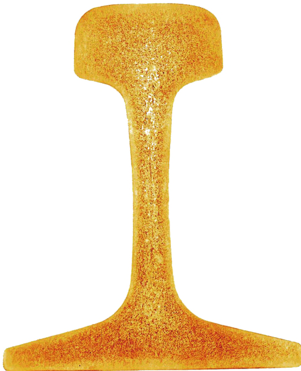
Рисунок И.6 — Осевая ликвация в шейке, простирающаяся в головку и (или) в подошву (серный отпечаток)
