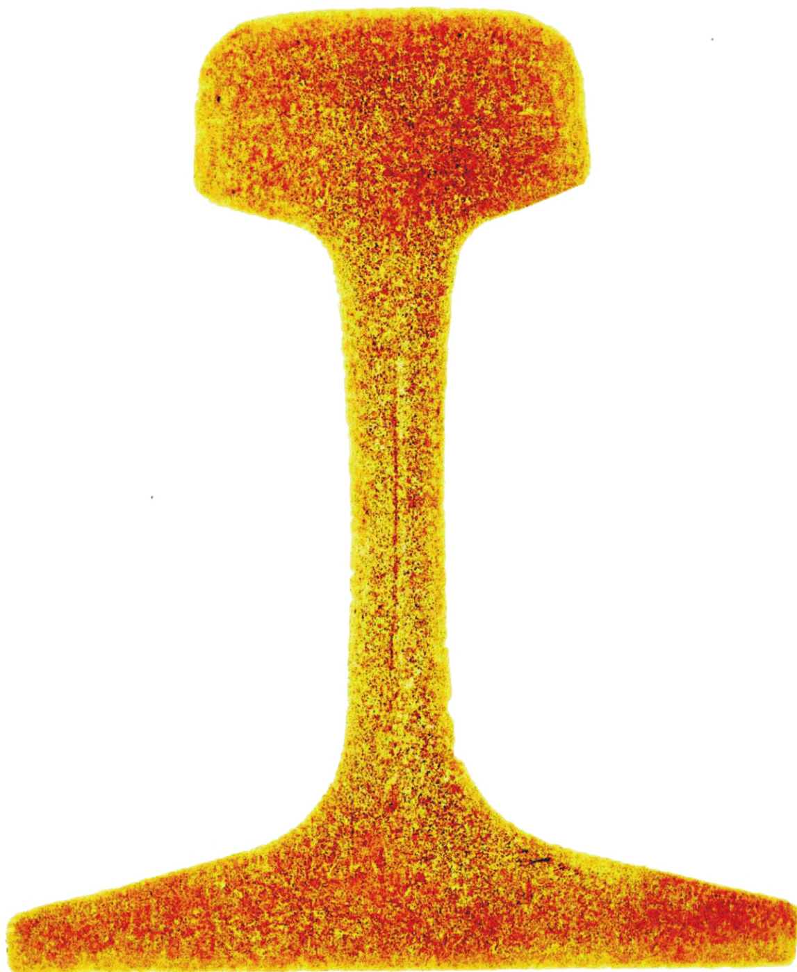
Рисунок И.14 — Ликвационные полосы (серный отпечаток)
