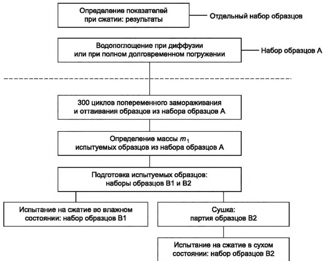
Рисунок 1 — Схема проведения испытаний
