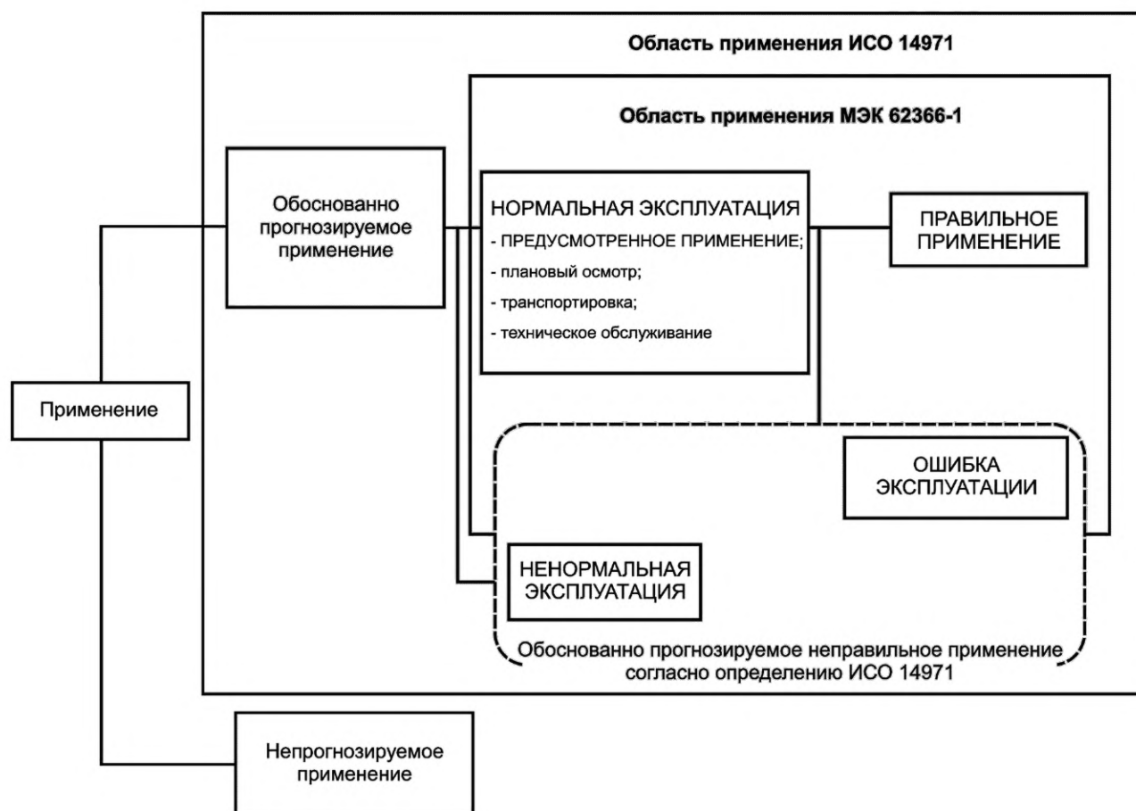
Рисунок А.4 — Типы применения, описанные в настоящем стандарте, и их связь с концепцией «обоснованно прогнозируемого неправильного применения» в ИСО 14971
