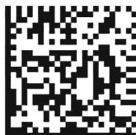
Рисунок 4 — Символ штрихового кода Data Matrix для сокращенного состава данных уникального идентификатора маркируемой единицы (экземпляра) металлопродукции
