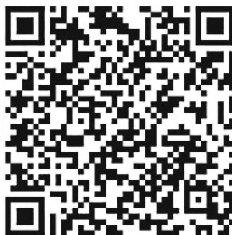
Рисунок 2 — Пример записи строки данных маркировки упаковки в символе штрихового кода символики QR Code
