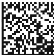
Рисунок 3 — Символ штрихового кода Data Matrix для строки данных уникального идентификатора маркируемой единицы (экземпляра) металлопродукции
