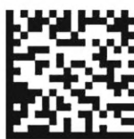
Рисунок 5 — Символ штрихового кода Data Matrix для сокращенного состава знаков на основе присвоения серийного номера
