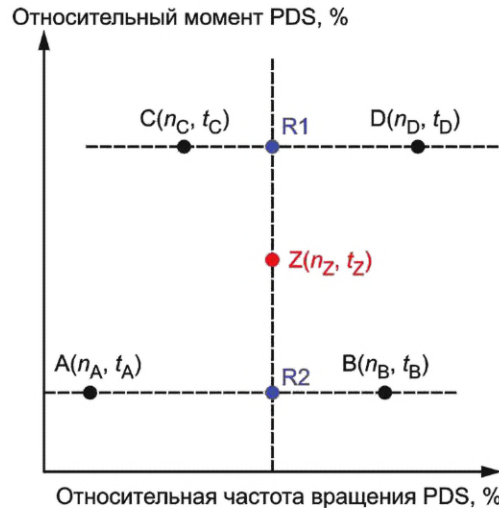
Рисунок 8 — Двухкоординатная интерполяция в окрестности опорных точек
