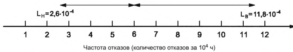
Рисунок С.2 — Оценка и доверительный интервал 95 % для примера расчета интенсивности отказа
