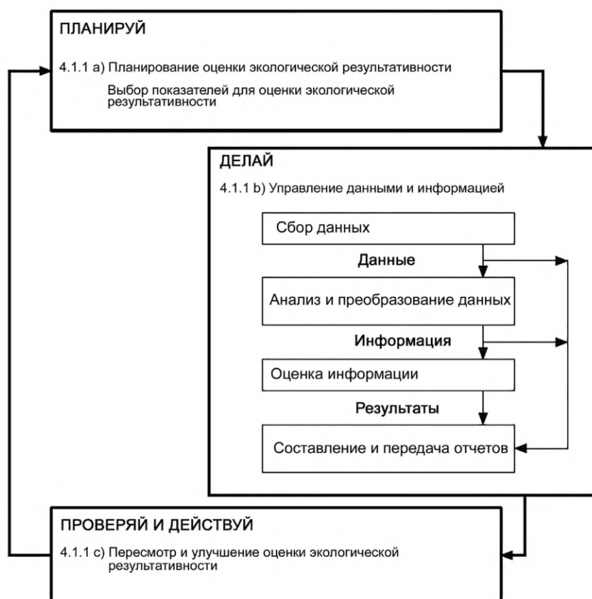
Рисунок 2 — Блок-схема проведения ОЭР на основе PDCA модели
