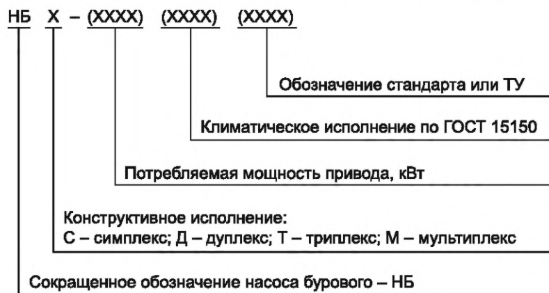
Рисунок 1 — Структура условного обозначения бурового насоса
