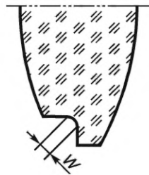
Рисунок 28 — Обозначения ширины скругления внутренней кромки
