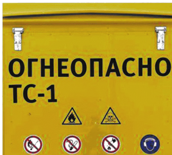
Рисунок 2 — Пример нанесения знаков безопасности на топливозаправщике
