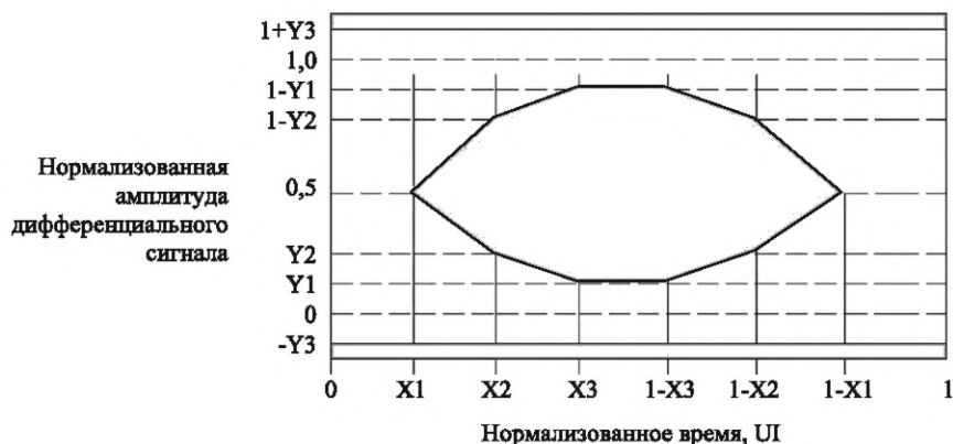
Рисунок 7.14 — Электрооптическая маска глазковой диаграммы передатчиков, предназначенных для работы с битовыми скоростями от 1 до 10 Гбит/с
