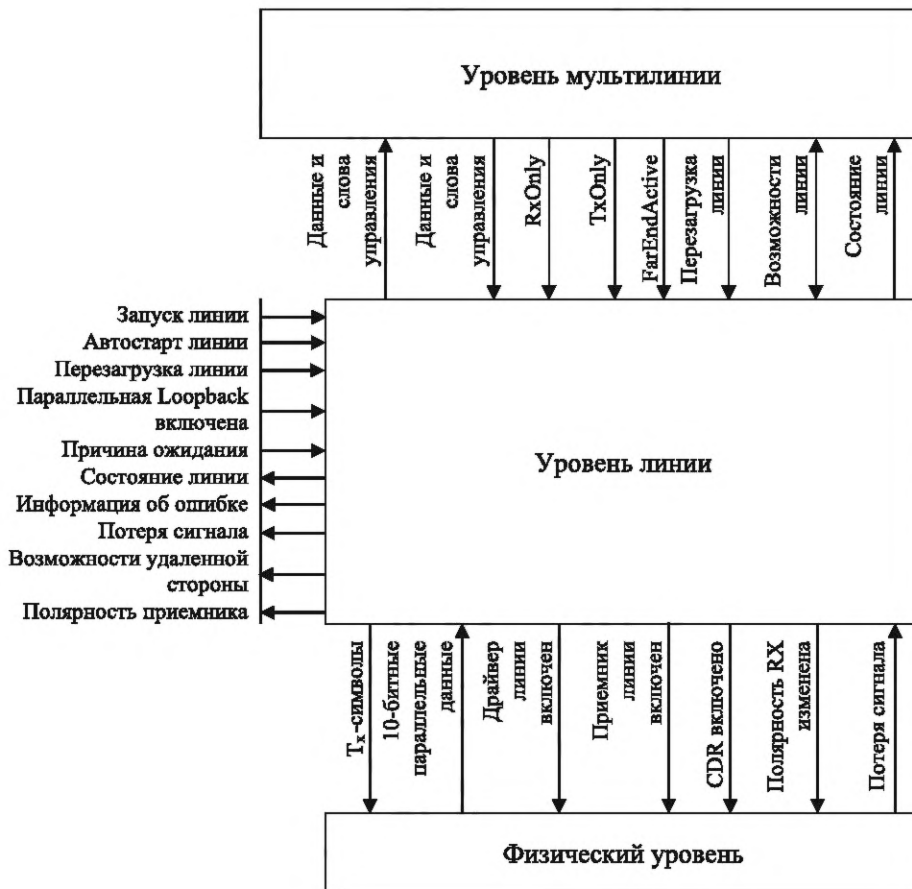
Рисунок 8.2 — Интерфейсы уровня линии для линка с мультилинией
