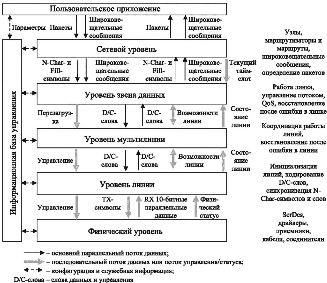
Рисунок 5.2 — Стек протоколов SpaceFibre-RUS для линка с мультилинией
