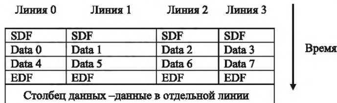
Рисунок 9.4 — Распределение данных по линку мультилинии
