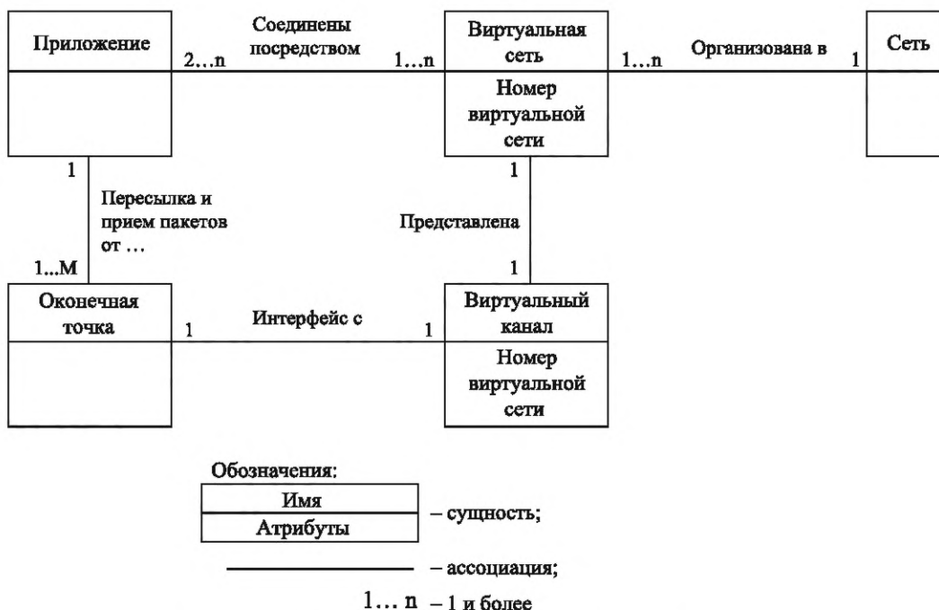
Рисунок 11.3 — Связи внутри виртуальной сети SpaceFibre
