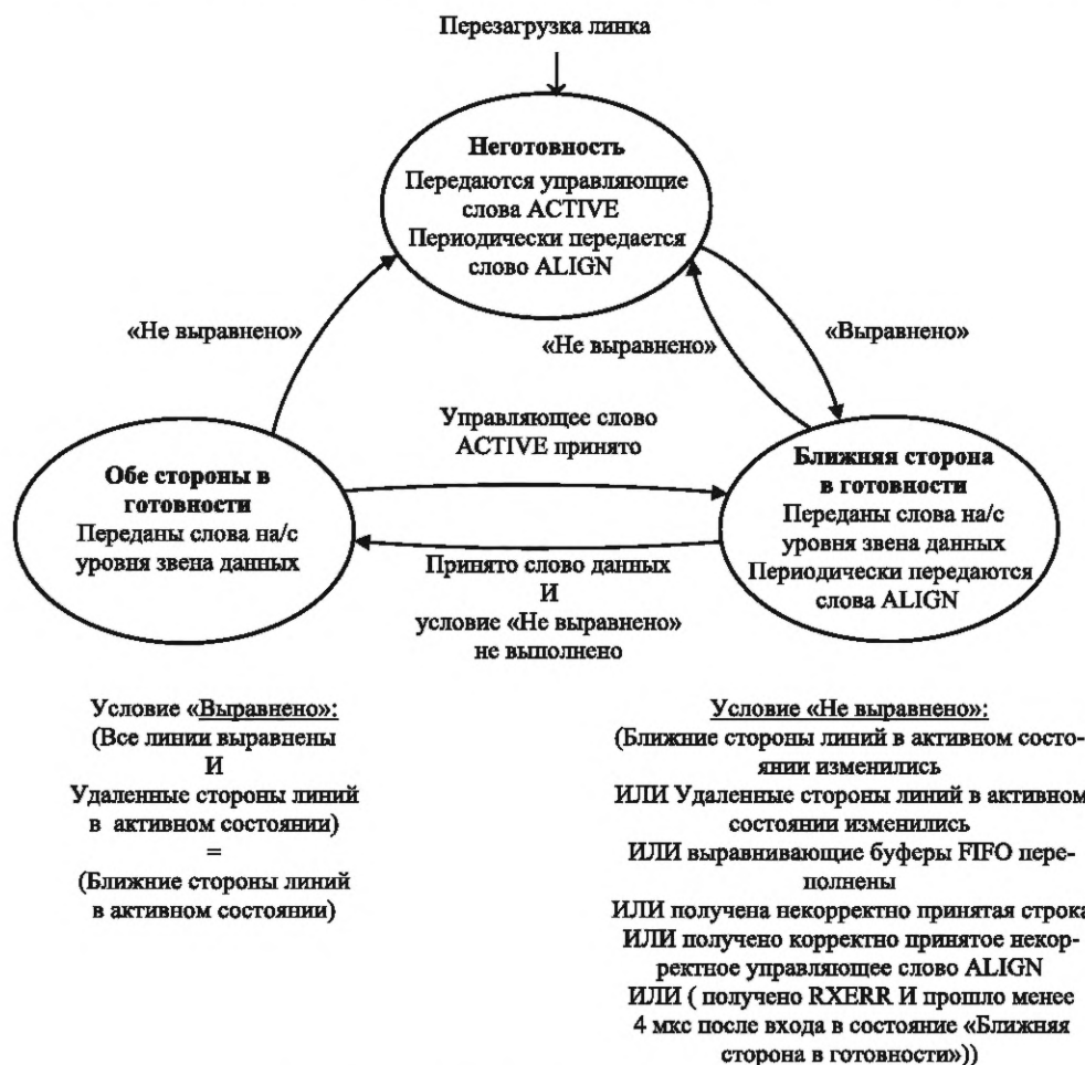
Рисунок 9.7 — Диаграмма состояний машины состояний выравнивания
