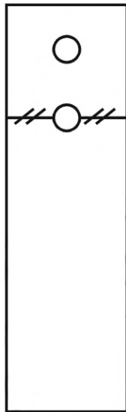
Рисунок В.9 — Разрушение при сжатии типа LGM: поперечное разрушение через центр отверстия (как правило, происходит вдоль направления армирования 0^\circ )
