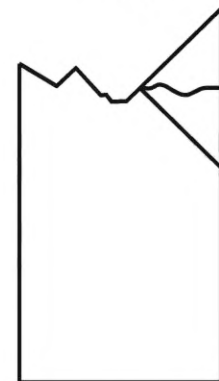
Рисунок В.8 — Разрушение при растяжении типа MGM: многотиповое разрушение через центр отверстия (сопровождается деламинацией и разделением на части)
