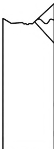
Рисунок В.13 — Разрушение при сжатии типа MGO: многотиповое разрушение по краю отверстия
