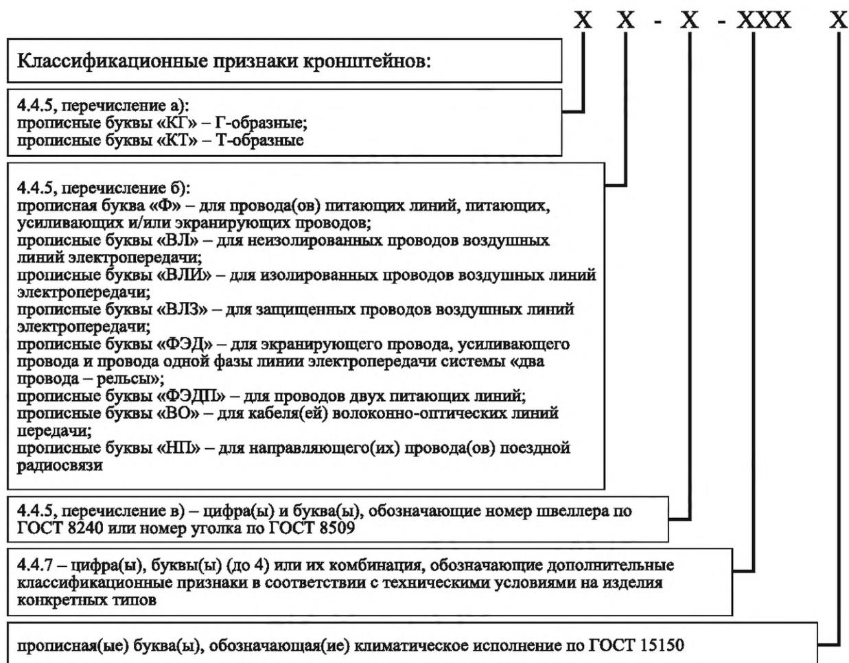
Рисунок 14 — Структурная схема условного обозначения кронштейна, предназначенного для крепления проводов или кабелей с вертикальной стойкой
