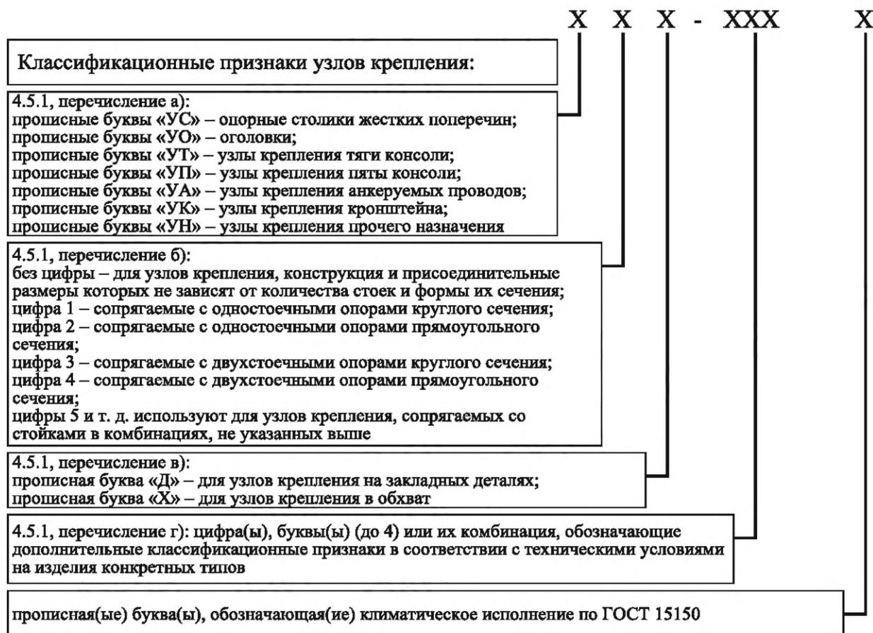
Рисунок 16 — Структурная схема условного обозначения узла крепления
