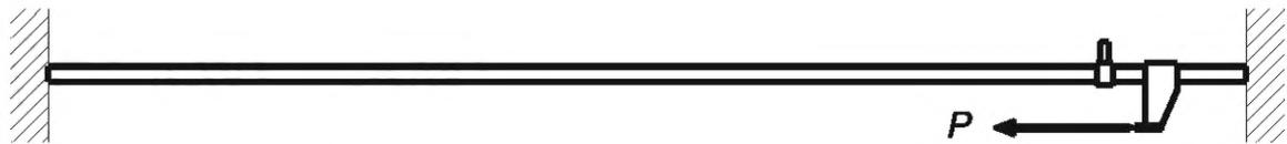
б) схема приложения нагрузки к основному стержню
