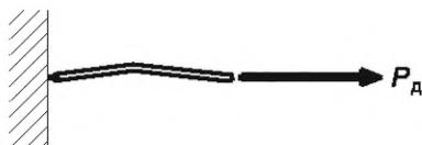
в) схема приложения нагрузки к дополнительному стержню
