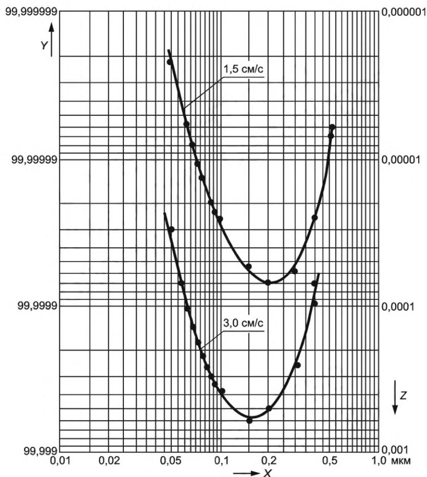
Рисунок 2 — Кривые зависимости фракционной эффективности  $E$  и фракционного проскока  $P$  фильтрующего материала сверхвысокой эффективности (ULPA) от диаметра  $d_p$  частиц для двух различных скоростей потока через материал (пример)
