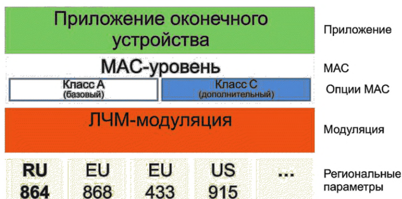
Рисунок 1 — Классы устройств LoRaWAN RU
