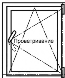
Рисунок Б.4 — Схема поворотно-откидного открывания с функцией щелевого
