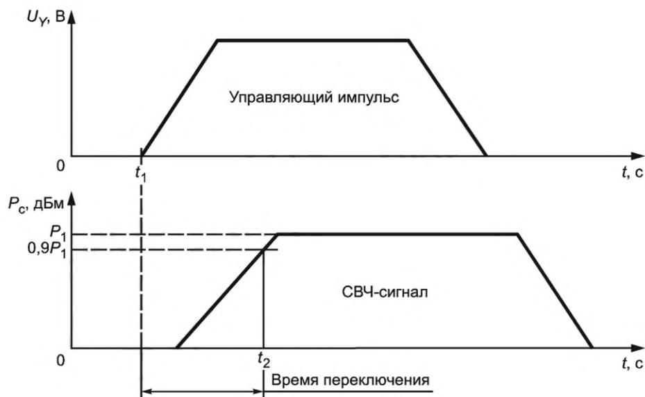
$U_\gamma$  — напряжение управляющего импульса;  $P_c$  — мощность сигнала;  $P_1$  — мощность СВЧ-сигнала на выходе ИУ;
