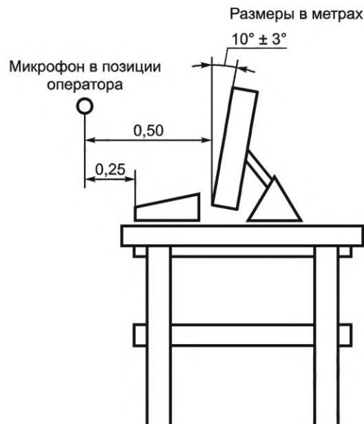
Рисунок ДА.4d — Установка оборудования типа моноблок
