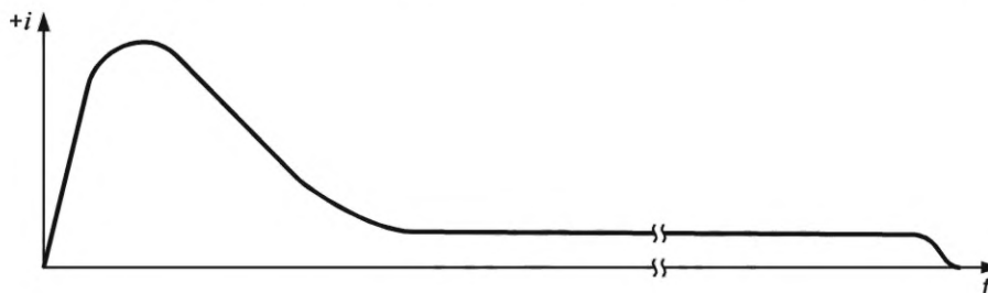
Рисунок В.6 — Типичный профиль положительной нисходящей молнии
