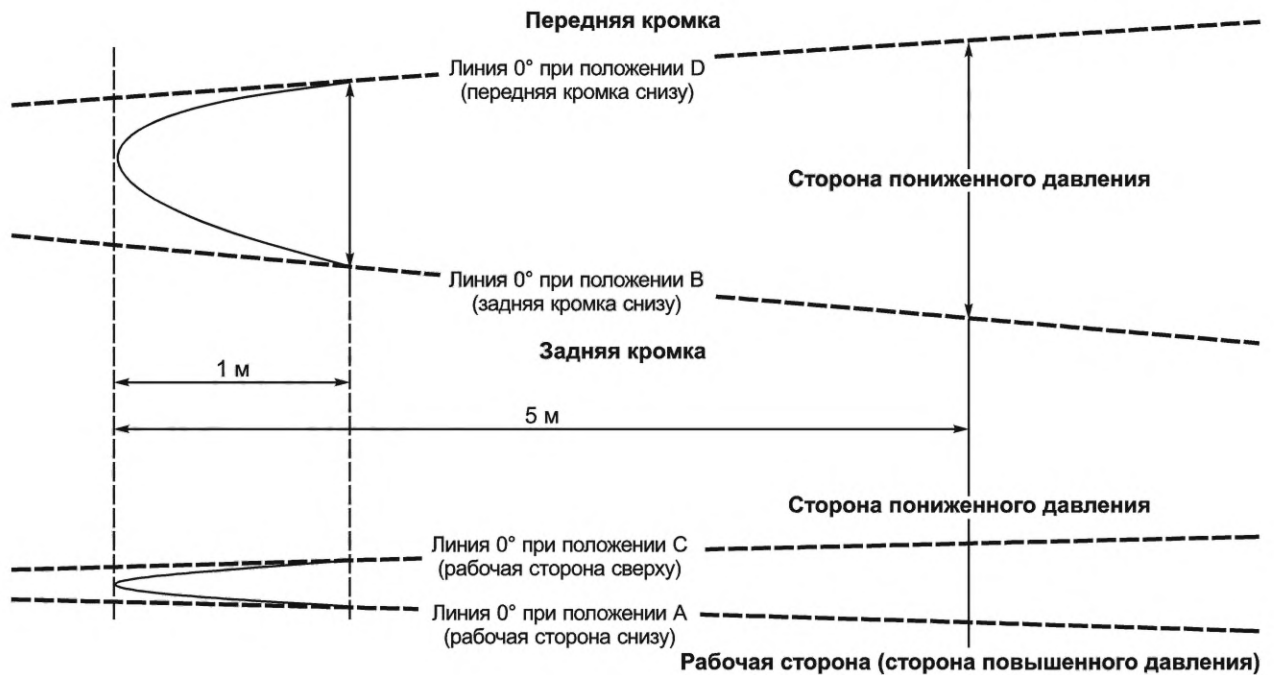
Рисунок С.3 — Определение оси по длине лопасти в ходе испытаний на попадание удара молнии (варианты положения лопасти А—D соответствуют рисунку С.2)
