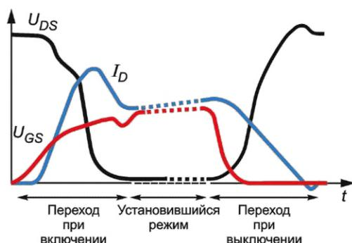
а) Коммутация индуктивной нагрузки с жестким включением и выключением<sup>1)</sup>
