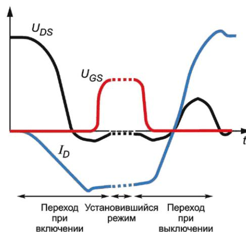
б) Переходы включения и выключения с мягким переключением<sup>2)</sup>
