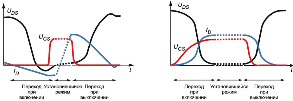
в) Переключение в резонансной топологии с плавным переключением, переходы включения и выключения с жесткой коммутацией
