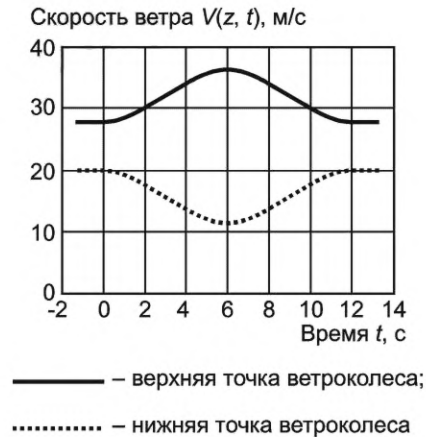
Рисунок 9 — Пример скоростей ветра в верхней и нижней точках ветроколеса, иллюстрирующий переходный положительный сдвиг
