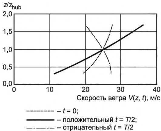
Рисунок 8 — Пример экстремального положительного и отрицательного вертикального сдвига ветра. Профиль ветра до начала сдвига (пунктирная линия) и при наибольшем сдвиге (сплошная линия)
