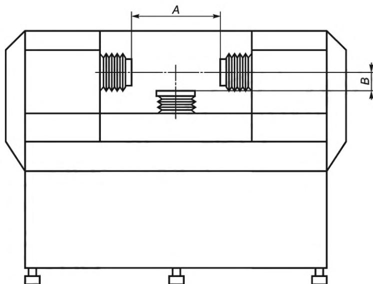
$A$  — наибольшее расстояние между торцами электрододержателей горизонтальных приводов;  $B$  — наибольшее расстояние между осью горизонтальных электрододержателей и торцом электрододержателя вертикального привода
