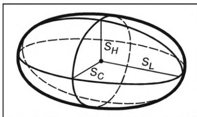
Рисунок 2 — Трехмерное пространство допусков СМС
