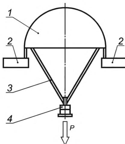
1 — противоударный шлем; 2 — опоры испытательного станда; 3 — подбородочный ремень; 4 — приспособление для нагружения
