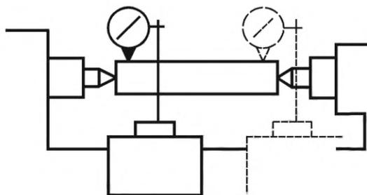
Рисунок 8 — Схема измерения с помощью средства измерений линейных размеров и контрольной оправки, установленной в центрах
