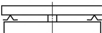
Рисунок 32 — Схема измерения отклонений от прямолинейности торцевой поверхности
