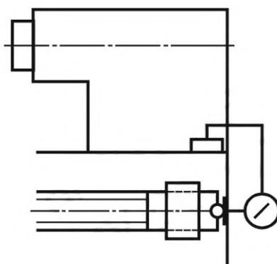
Рисунок 26 — Схема измерения осевого биения ходового винта
