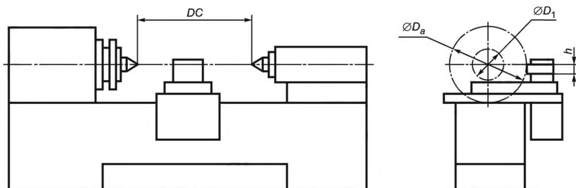
$D_a$  — наибольший диаметр заготовки;  $DC$  — наибольшее расстояние между центрами передней и задней бабок;  $D_1$  — наибольший диаметр заготовки, обрабатываемой над суппортом;  $h$  — наибольшая высота резца, устанавливаемого в резцедержателе
