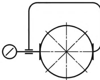
Рисунок 31 — Схема проверки постоянства диаметров образца-изделия с помощью средства измерений линейных размеров
