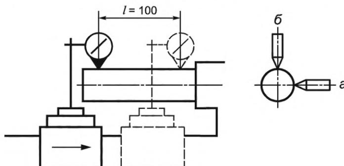
Рисунок 20 — Схема измерения отклонений от параллельности направления перемещения суппорта относительно оси наружной поверхности пиноли
