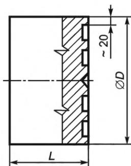
Рисунок 29 — Образец-изделие для проверки прямолинейности торцевой поверхности
