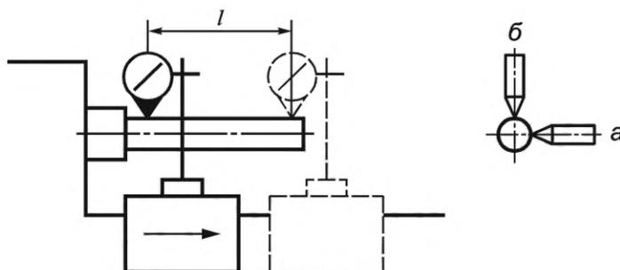
Рисунок 18 — Схема измерения отклонений от параллельности и прямолинейности направления перемещения суппорта относительно оси вращения шпинделя
