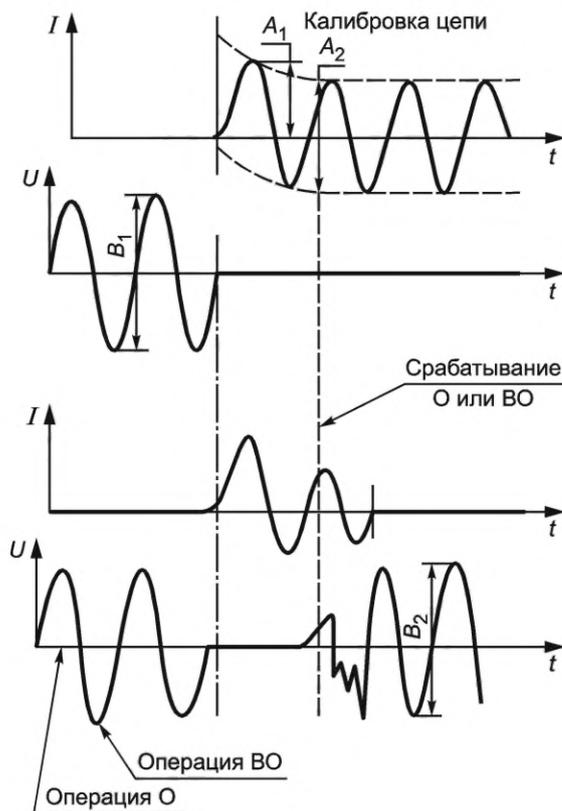
$A_1$  — ожидаемый пиковый ток включения;  $\frac{A_1}{2\sqrt{2}}$  — ожидаемый симметричный ток отключения (действующее значение);
