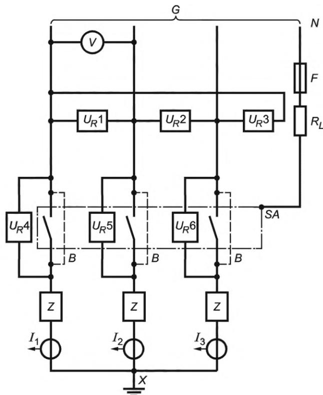
$B$  — временные калибровочные соединения;  $SA$  — испытуемый аппарат (с соединительными кабелями);  $F$  — плавкий элемент;  $I_1, I_2, I_3$  — датчики тока;  $N$  — нейтраль источника питания (или искусственная нейтраль);  $R_L$  — сопротивление, ограничивающее аварийный ток;  $G$  — источник питания;  $X$  — заземление (только в одной точке, на выходной стороне);  $U_{R1}, U_{R2}, U_{R3}, U_{R4}, U_{R5}, U_{R6}$  — датчики напряжения;  $V$  — вольтметр;  $Z$  — цепь нагрузки (см. чертеж 6)
