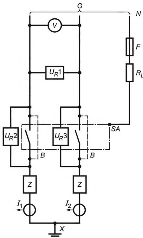
$B$  — временные калибровочные соединения;  $SA$  — испытуемый аппарат (с соединительными кабелями);  $F$  — плавкий элемент;  $I_1, I_2$  — датчики тока;  $N$  — нейтраль источника питания (или искусственная нейтраль);  $R_L$  — сопротивление, ограничивающее аварийный ток;  $G$  — источник питания;  $X$  — заземление (только в одной точке, на выходной или входной стороне);  $U_{R1}, U_{R2}, U_{R3}$  — датчики напряжения;  $V$  — вольтметр;  $Z$  — цепь нагрузки (см. чертеж 6)
