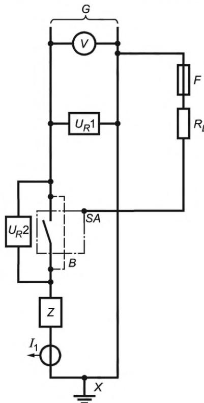
*B* — временное калибровочное соединение; *SA* — испытываемый аппарат (с соединительными кабелями); *F* — плавкий элемент; *I<sub>1</sub>* — датчик тока; *R<sub>L</sub>* — сопротивление, ограничивающее аварийный ток; *G* — источник питания; *X* — заземление (только в одной точке, на выходной или входной стороне); *U<sub>R1</sub>*, *U<sub>R2</sub>* — датчики напряжения; *V* — вольтметр; *Z* — цепь нагрузки (см. чертеж б)
