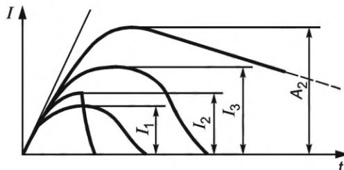
$I_1$  — первая калибровка;  $I_2$  — фактический ток отключения;  $I_3$  — вторая калибровка;  $A_2$  — отключающая способность
