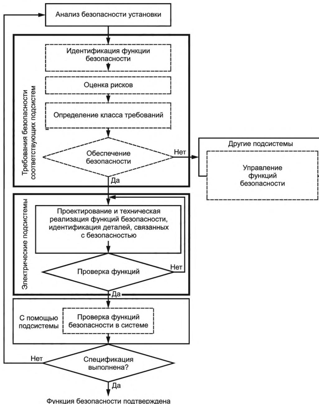
Рисунок 2 — Алгоритм (функциональная схема) процесса снижения риска
