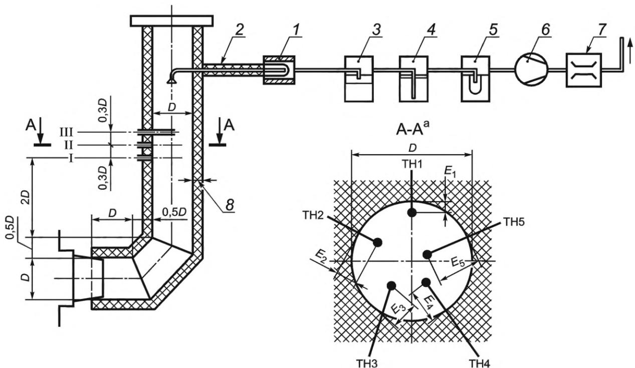
1 — фильтр; 2 — отбор пробы газа и трубка для измерения концентрации пыли (теплоизоляция); 3 — сепаратор воды; 4 — силикагелевый фильтр; 5 — фильтр точной очистки; 6 — насос; 7 — счетчик расхода газа; 8 — изоляция  $t = 40 \text{ мм}$ ; I — патрубок для измерения тяги; II — патрубок для измерения температуры, патрубок пробоотборника для анализа отводных газов (пробоотборный крест); III — патрубок для измерения сажи
