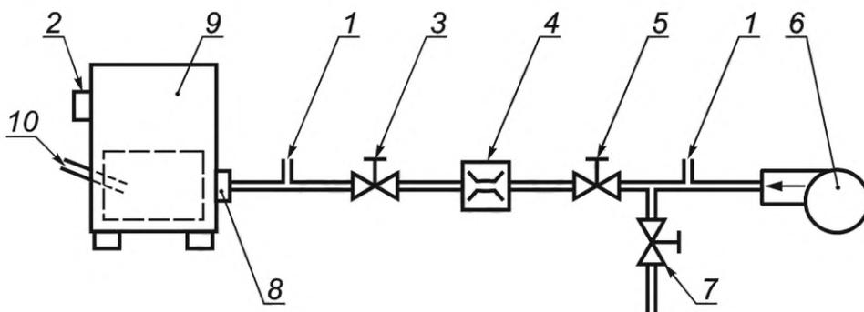
1 — точки измерения давления; 2 — вытяжной патрубок; 3 — задвижка 1 (дроссельная); 8 — воздухозабор котла; 9 — испытательный котел; 10 — давление в топке
