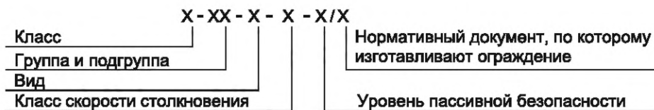
Рисунок А.3 — Последовательность расположения букв и цифр условного обозначения марки фронтального ограждения
