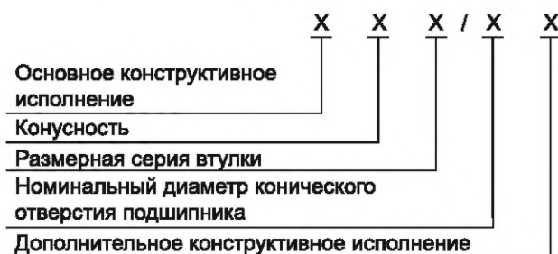
Рисунок 2 — Схема условного обозначения втулок подшипника номинальным диаметром свыше 450 мм
