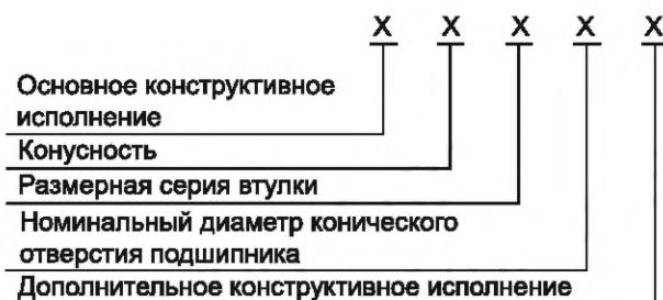
Рисунок 1 — Схема условного обозначения втулок подшипника номинальным диаметром до 450 мм
