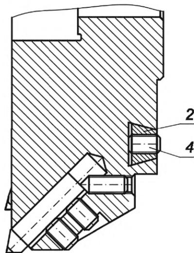
1 — корпус; 2 — сухарь; 3 — винт; 4 — винт; 5 — вставка режущая по ГОСТ Р 71305
